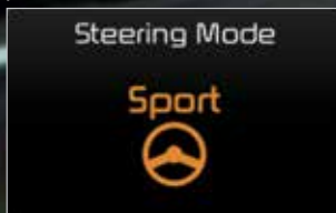
Fleksibilno upravljanje upravljačem Birajte između tri načina i prilagodite način upravljanja različitim uslovima vožnje: Normal za uobičajene uslove, Comfort za olakšano upravljanje u gradskoj vožnji i lakše parkiranje i Sport za vožnju autoputeom. Standardno kod modela sa ručnim menjačem.
